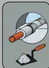
Restöffnung hohlraumfrei mit Brandschutzmörtel verschließen.
