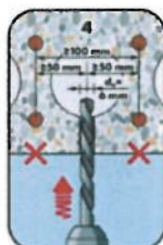
Bohrloch herstellen. Abstände beachten
