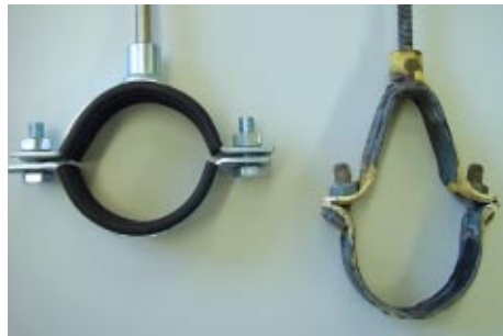
Bild 10: Rohrschellen vor und nach Brandbeanspruchung
