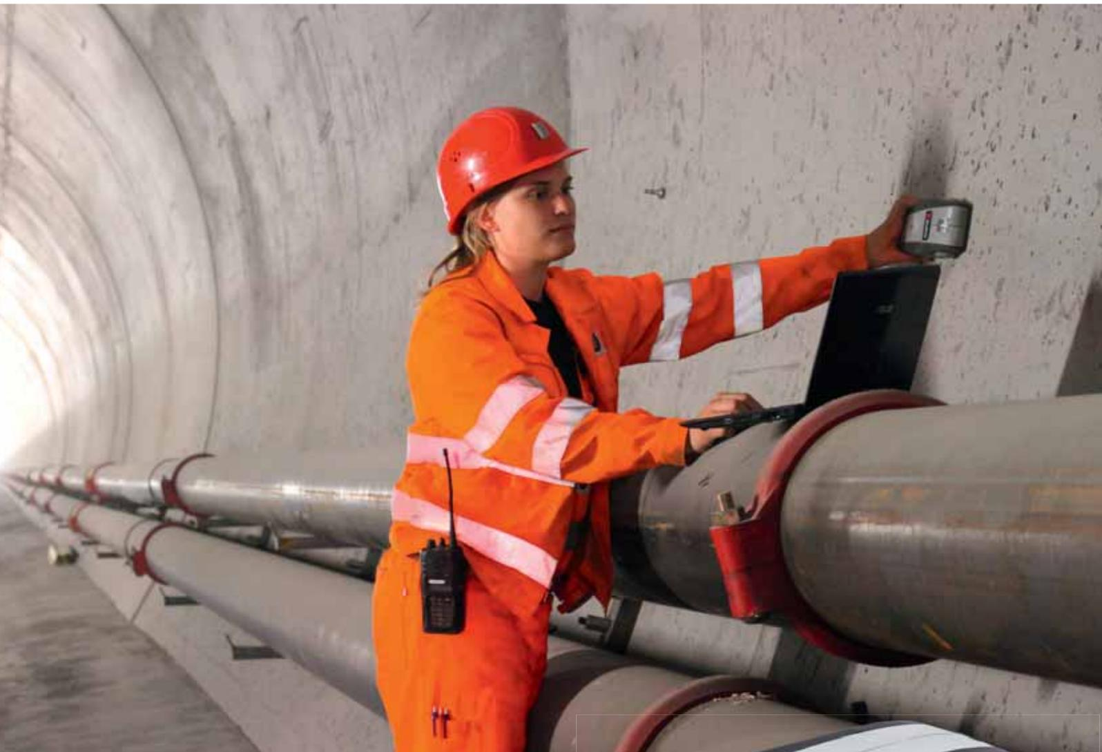
**Das Würth Betondeckungs-Messgerät BDM1 für die schnelle Qualitätssicherung auf der Baustelle**
