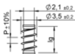
Unterkopfgewinde Lg2 < 4 \times d , P = 1,6; 2,2; 3,2
