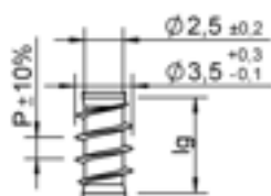
Unterkopfgewinde Lg2 < 4 \times d , P = 1,6
