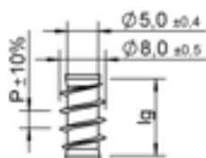
Unterkopfgewinde Lg2 < 4 \times d , P = 3,6
