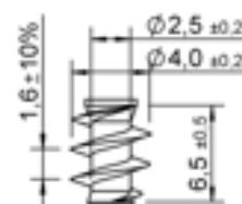
Unterkopfgewinde Typ P
