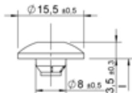
Torbandkopf – mit und ohne Fräskanten, mit und ohne Schaftverstärkung
