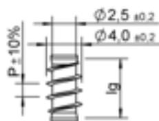
Unterkopfgewinde Lg2 < 4 \times d , P = 1,8; 2,6; 3,6
