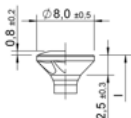
Senkkopf – mit und ohne Linse, mit und ohne Frästaschen
