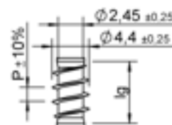
Unterkopfgewinde Lg2 < 4 \times d , P = 1,8; 2,2
