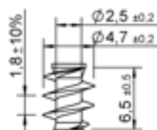
Unterkopfgewinde Typ P
