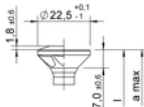
Senkkopf – mit und ohne Linse, mit und ohne Frästaschen
