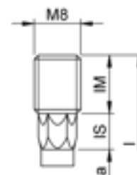
Gewindebolzenkopf mit und ohne Sechskant
