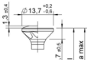
Senkkopf – mit und ohne Linse, mit und ohne Frästaschen
