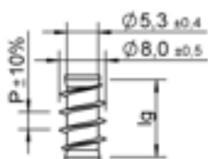
Unterkopfgewinde Lg2 < 4 \times d , P = 5,6
