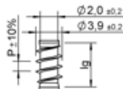
Unterkopfgewinde Lg2 < 4 \times d , P = 1,6; 2,0; 2,2; 3,2
