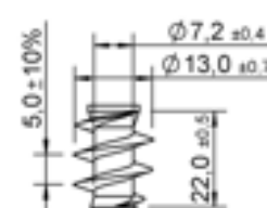
Unterkopfgewinde Typ P
