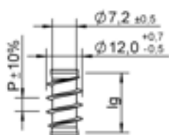
Unterkopfgewinde L_{g2} < 4 \times d , P = 6,6
