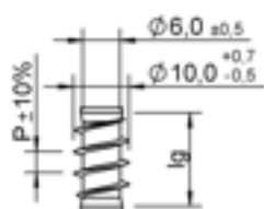
Unterkopfgewinde Lg2 < 4 \times d , P = 4,4
