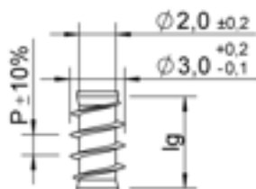
Unterkopfgewinde - Lg2 < 4 \times d p = 1,35; 1,9; 2,7
