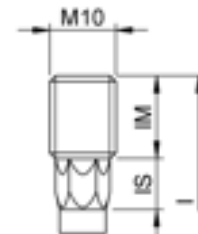
Gewindebolzenkopf – mit und ohne Sechskant
