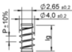
Unterkopfgewinde Lg2 < 4 \times d , P = 1,8
