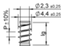
Unterkopfgewinde Lg2 < 4 \times d , P = 1,8; 2,2; 2,6; 3,6
