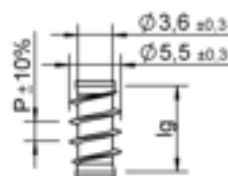
Unterkopfgewinde Lg2 < 4 \times d P = 1,8
