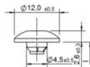
Torbandkopf – mit und ohne Fräskanten, mit und ohne Schaftverstärkung
