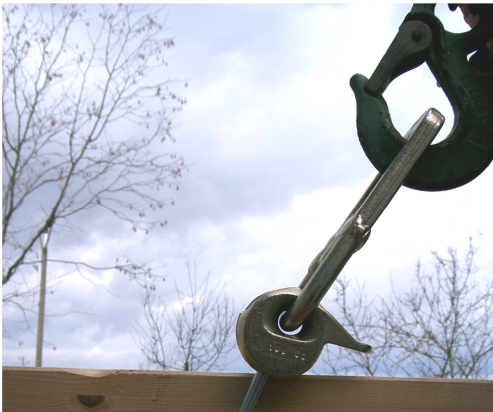
Bild 1: Transportankersystem mit DEHA Universal-Kupplung Lastgruppe 1-1,3
