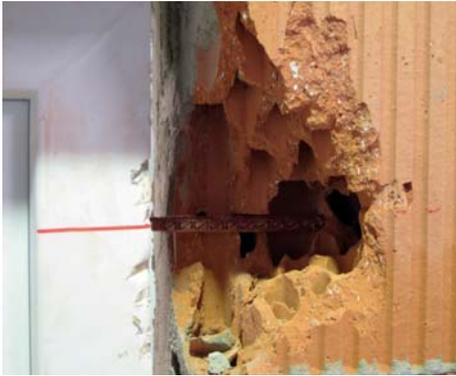
Bild 2: Freigelegte Verankerung nach manuellem Angriff
