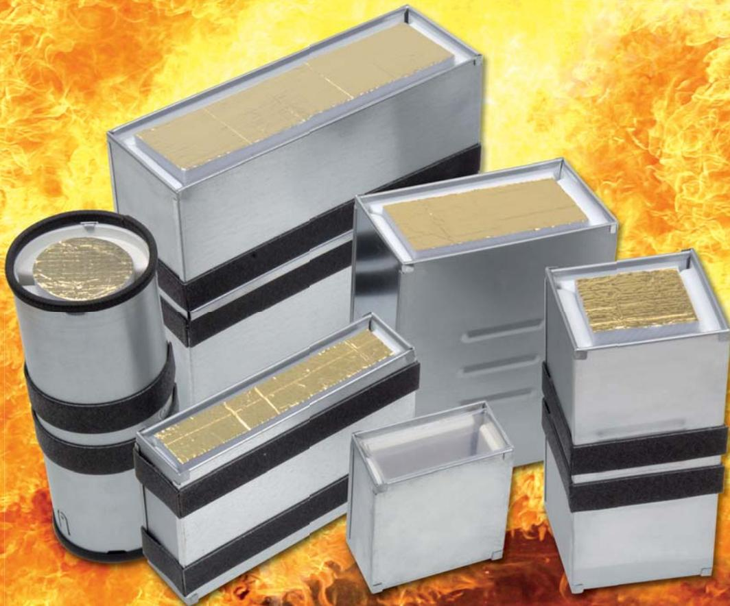
**Würth Kabelboxen** sind die zeitgemäße Antwort auf die Brandschutzvorschriften bei Kabeldurchführungen für Wände und Decken. Die Boxen sind leicht zu montieren und auch für Nachinstallationen bestens geeignet: Einfach in die Rohbauöffnung schieben, mit Brandschutzzement oder Montageschaum PURlogic® EASY fixieren – fertig!
