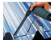
Mit der Verlängerung können Bleche mit einer Sickentiefe von bis zu 160 mm durchtrennt werden.
