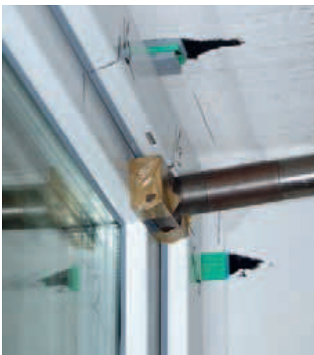
Bild 3 + 4: Statische Druckbelastung der Verriegelungspunkte und Rissbildung in der Wandecke
