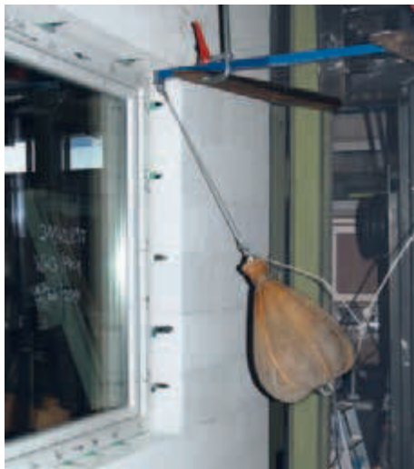
Bild 5: Dynamischer Versuch mit einem Sandsack (30 kg)
