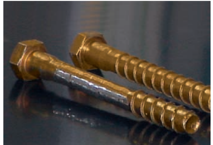
Bild 3: Schraubanker, die in den Versuchen mit h_{\text{gew}} < h_{\text{ef}} verwendet wurden [4]
