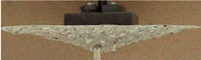
Bild 9a: Ausbruchkegel eines Schraubankers mit d_0 = 14 \text{ mm} bei s/h_{\text{nom}} = 1 ( h_{\text{nom}} = 50 \text{ mm} )
