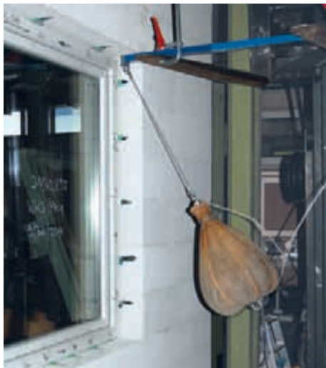
Bild 5: Dynamischer Versuch mit einem Sandsack (30 kg)
