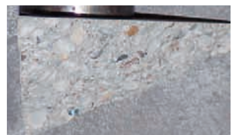
Bild 6: Typischer Ausbruchkegel einer Einzelbefestigung mit Schraubankern bei einem Eckabstand von c/h_{ef} \sim 0,5 ( d_0 = 10 mm, h_{nom} = 70 mm, C20/25) [4]
