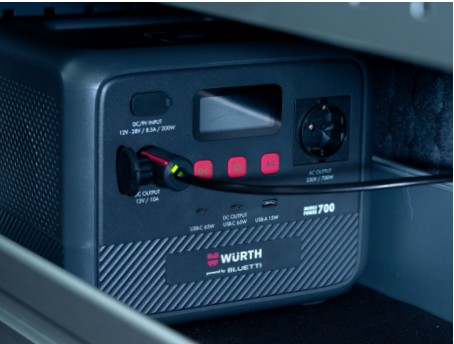
Mobile Powerstation: Würth Mopo 700 mit 700 W Ausgangsleistung (Nennenergie 504 Wh)
