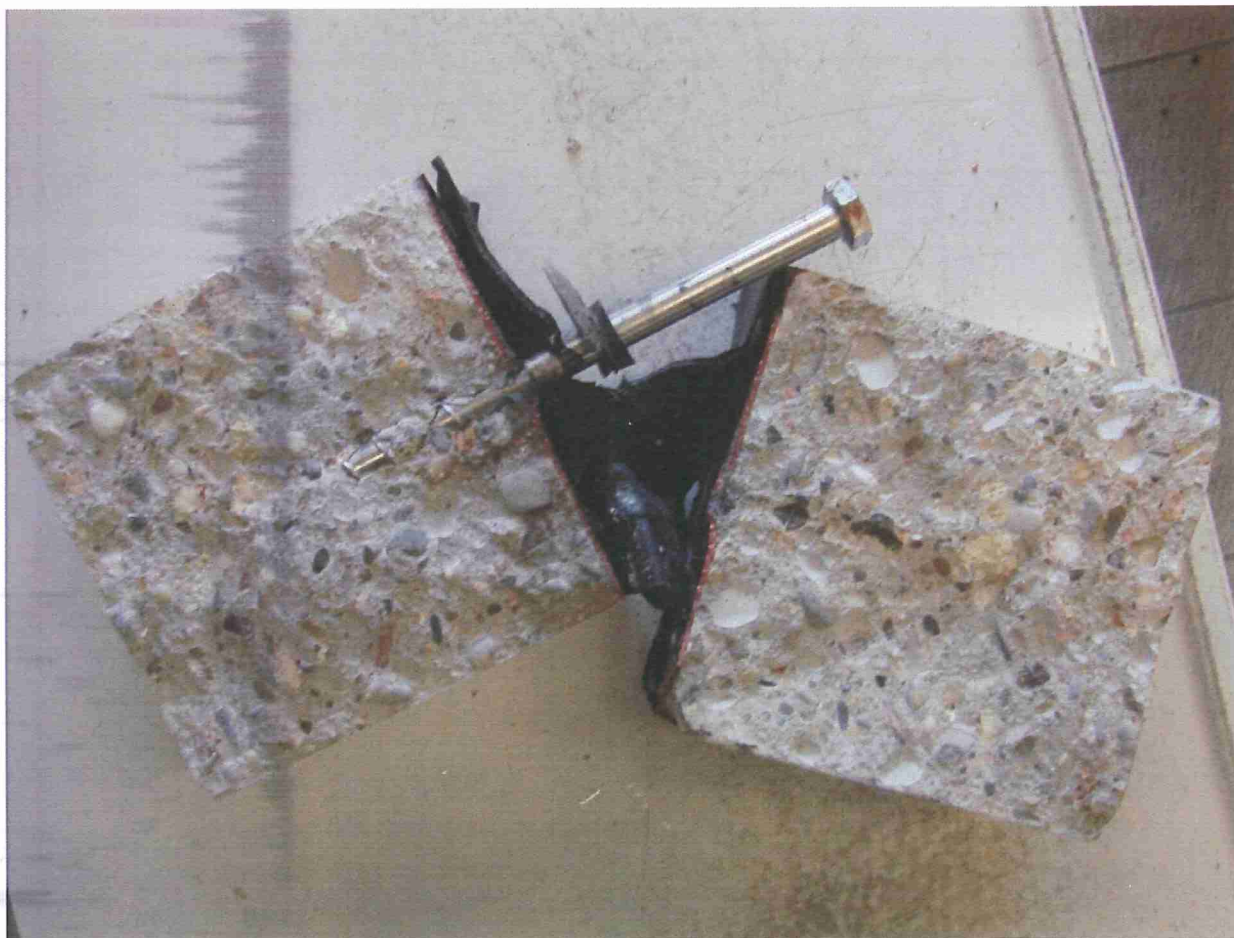
Ein nach der Druckprüfung gespaltener Betonwürfel
