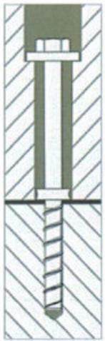
TOGE Betonschrauben TSM zur Verwendung als Beton-Betonverbinder
