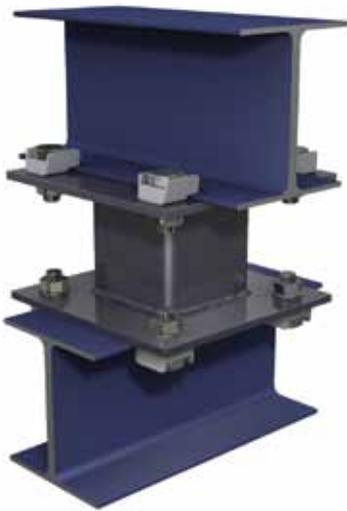
Um 90° versetzte Träger mit Montagestützen
