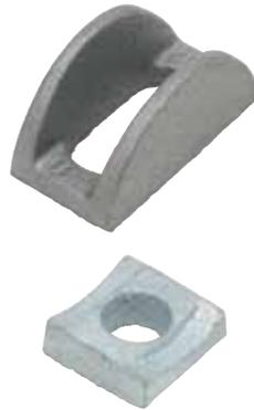
Die Spannelemente dienen der Verbindung von Gewinde- bzw. Zugstangen mit Stahlkonstruktionen. Ein Spannelement besteht aus einem Kurvenstück und einer Passscheibe. Sie ermöglichen ein Anpassen an den jeweiligen Neigungswinkel zwischen Zugstange und Stahlkonstruktion.
