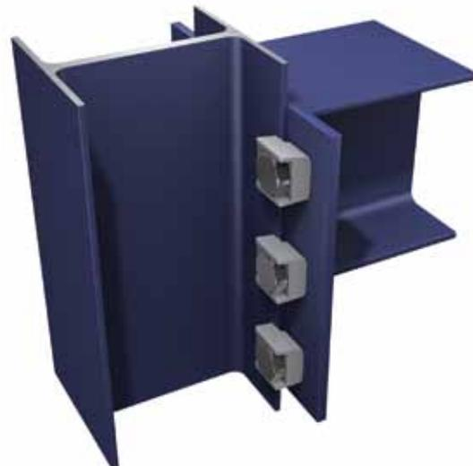
Anbindung eines horizontalen Stahlträgers mit entsprechen gelochter Kopfplatte an vertikale Träger
