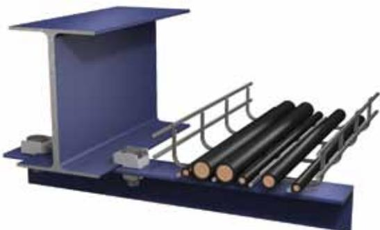
Winkelprofil als Träger für Kabelkanal an Stahlträger
