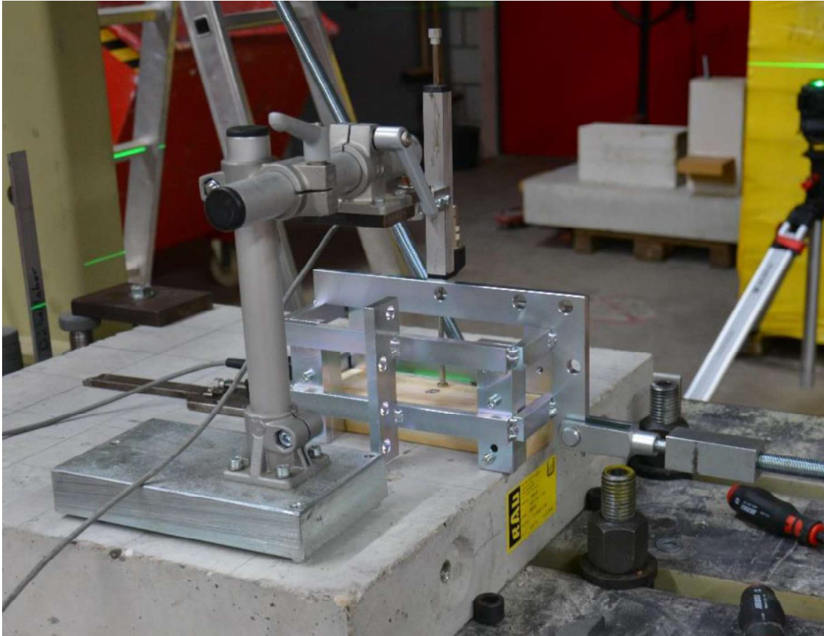
Abbildung 3 Versuchsaufbau mit käfigartiger Lasteinleitung – hier: Querlastversuche [7]
