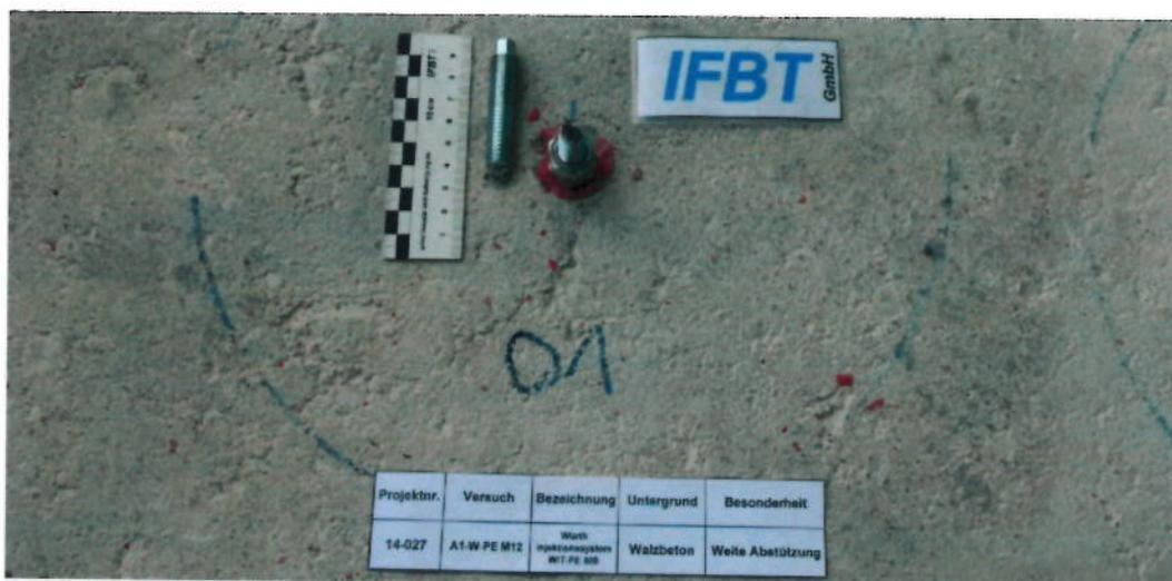
Abbildung 3: Versagensfall – Stahlversagen M12
