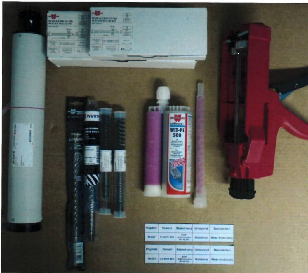
Abbildung 2: Verwendetes System – Hilti Verbundanker W-PE
