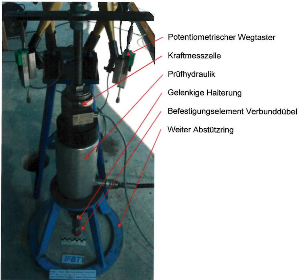
**Abbildung 1: Allgemeiner Versuchsaufbau der zentrischen Zugversuche**
