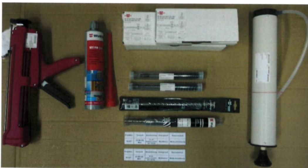
Abbildung 5: Verwendetes System – Würth Verbundanker W-VM
