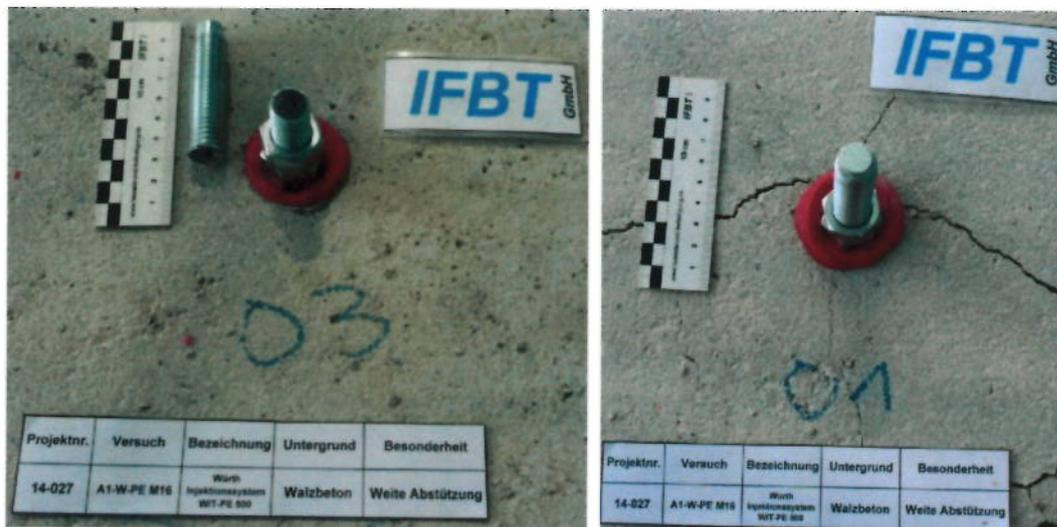
Abbildung 4: Versagensfall – Stahlbruch links, Walzbetonausbruch rechts; M16
