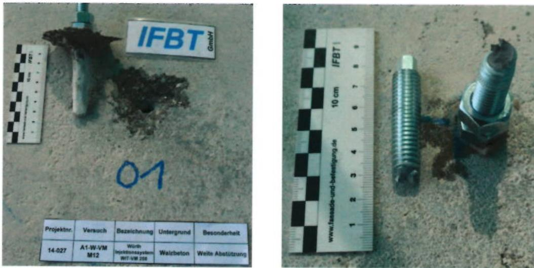
Abbildung 6: Versagensfall – Stahlbruch links, Walzbetonausbruch rechts; M12
