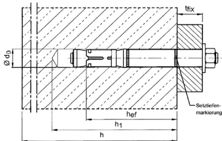
**Würth Hochleistungsanker W-HAZ/S, W-HAZ/A4**
