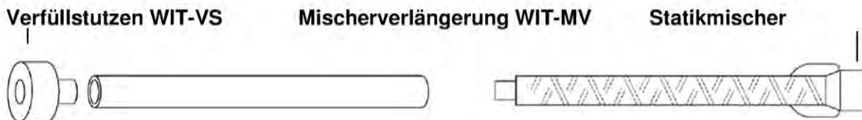
**Injektionssystem WIT-PE 500**
