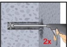
2f. Abschließend das Bohrloch erneut vom Bohrlochgrund her 2x vollständig mit Druckluft (min. 6 bar) (Anhang B 4) ausblasen, bis die ausströmende Luft staubfrei ist. Bei tiefen Bohrlöchern sind Verlängerungen zu verwenden.
