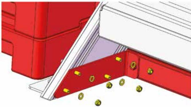
Bild 24 – Montage Traverse
