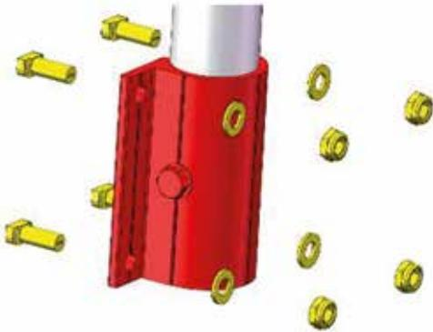
Bild 12 – Montage Podest-Geländer Vorderseite
