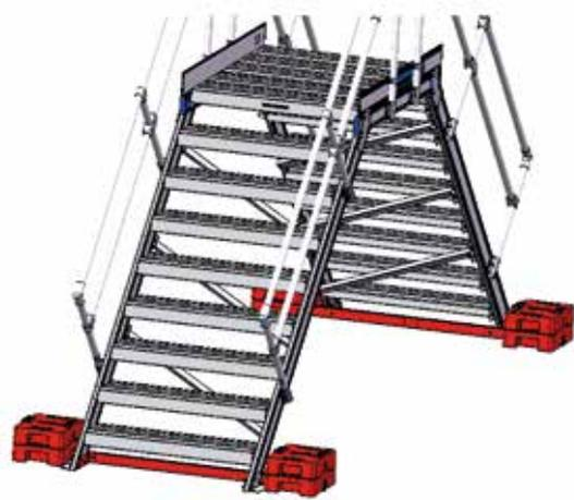
Bild 22 – Montage mit Auflasttraverse
