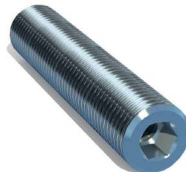
Bild 10: Befestigungssystem BS 100: M16-Gewindestange aus nichtrostendem Stahl mit Innengewinde M8 und Innensechskant zur Montage (Bildquelle: febatec)
