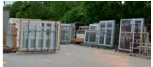
Bild 2. Fenster zur Prüfung in starrem Stahl- oder Holzrahmen montiert (Foto: Küenzlen)
