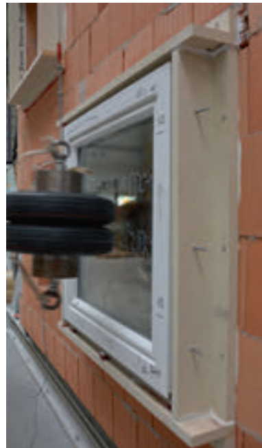
Bild 54. Dynamischer Anprall in Anlehnung an DIN EN 1629 bei einem RC-2-Fenster montiert in einem PUR-Composit-Werkstoff (Foto: Künzlen)
