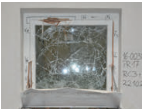
Bild 41. Ergebnis des mechanischen Angriffs auf die Brüstung mit und ohne Fenstersturz in der Widerstandsklasse RC 3 (Foto: Küenzlen)
