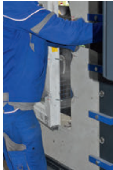
Bild 46. Manueller Einbruchversuch in der Klasse RC 3 in Beton C30/37 als Tastversuch: Herausbrechen des seitlich nicht verklotzten Fensterelements bei Einsatz eines Kuhfußes (Foto: Küenzlen)
