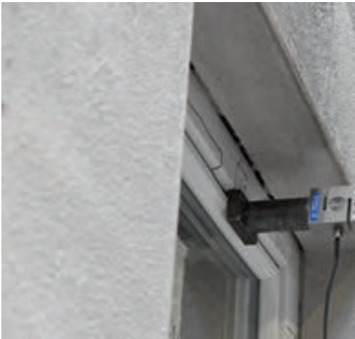
Bild 3. Statische Druckbelastung der Verriegelungspunkte bei der Prüfung nach DIN EN 1628 in der Klasse RC 2 (Foto: Künzlen)
