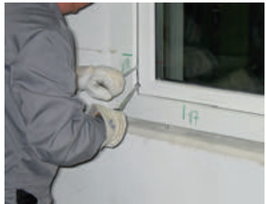
Bild 5. Manuelle Einbruchprüfung: Angriff auf das Fenster in einer Porenbetonwand (Foto: Künzlen)
