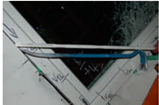
Bild 9. Kufuß aus Werkzeugsatz für manuelle Einbruchversuche nach DIN EN 1630 in der Widerstandsklasse RC 3 [5]
