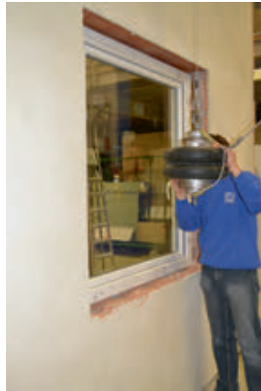
Bild 4. Dynamischer Versuch in der Klasse RC 2 mit einem Doppelreifenpendel (50 kg) [6]
