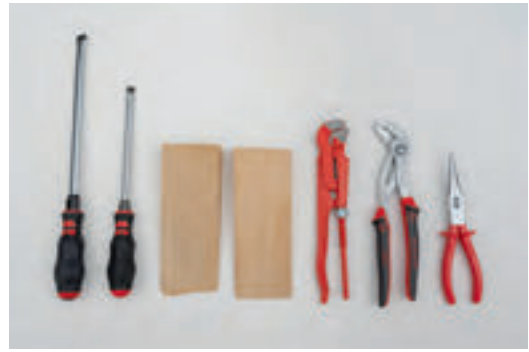
Bild 8. Auswahl aus dem Werkzeugsatz für manuelle Einbruchversuche nach DIN EN 1630 in der Widerstandsklasse RC 2 (Foto: Petter)
