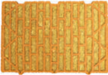
Bild 27. In den Versuchen verwendeter Wärmedämmziegel mit Kleinlochung (unipor W07 – Zulassung Z-17.1-1074)
