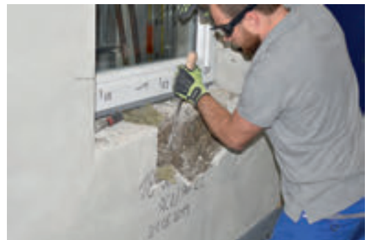
Bild 31. Manueller Einbruchversuch in Mauerwerk aus Leichtbeton in der Druckfestigkeitsklasse 2 (Foto: Künzlen)
