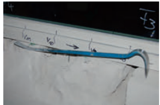
Bild 40. Versuch, mit dem Kuhfuß innerhalb von fünf Minuten direkt durch die 36,5 cm dicke Wand zu brechen [5]
