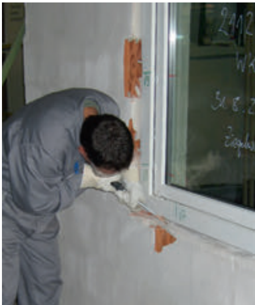
Bild 13. Manuelle Einbruchsprüfung (Angriff auf den Verankerungsgrund) in einer Wand aus Hochlochziegeln der Druckfestigkeitsklasse 12 [2]
