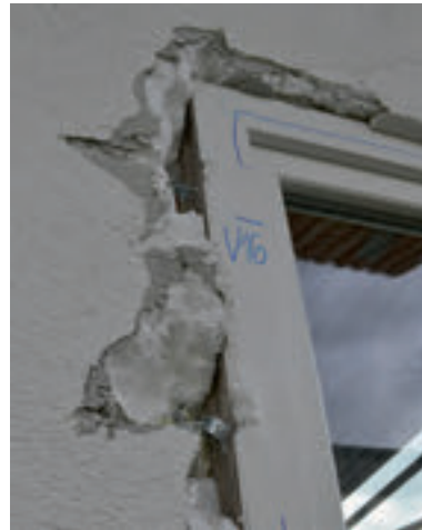
Bild 50. Manueller Angriff auf die Verbindung Konsole – Fensterprofil [32]
