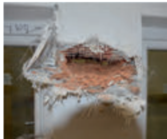
Bild 43. Ergebnis des mechanischen Angriffs auf einen Pfeiler aus zwei Steinen in der Widerstandsklasse RC 3 (Fotos: Küenzlen)
