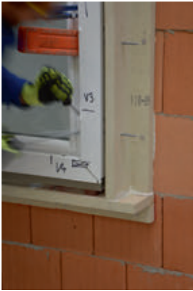
Bild 55. Manueller Angriff in Anlehnung an DIN EN 1630 auf ein bereits zertifiziertes RC-2-Fenster montiert in einem PUR-Composit Werkstoff (Foto: Künzlen)
