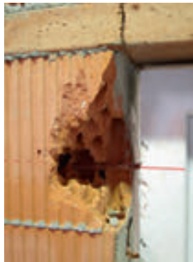
Bild 22. In den Versuchen verwendeter Großkammerziegel Thermopor TV 7 nach abZ/aBG Thermopor [30]
