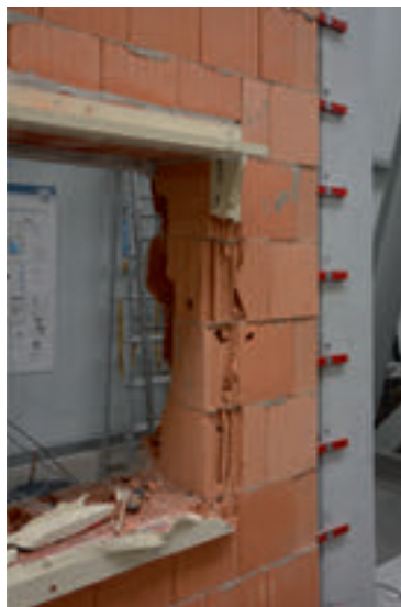
Bild 56. Manueller Angriff in Anlehnung an DIN EN 1630 auf die Befestigung im einem PUR-Composit Werkstoff und die Klebung mit Baugrund Hochlochziegel (Fotos: Künzlen)
