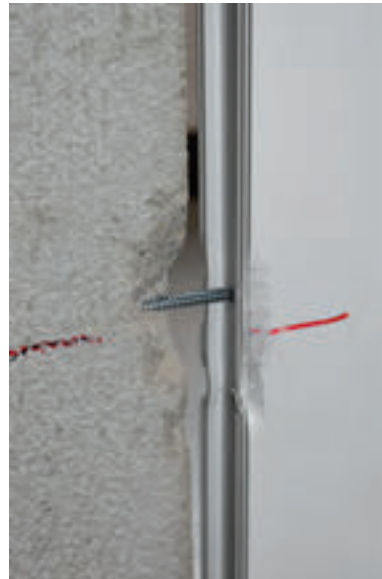
Bild 35. Beschädigung durch manuellen Einbruchversuch in der Klasse RC 2 mit Schraubendreher in Beton C30/37 (Foto: Küenzlen)
