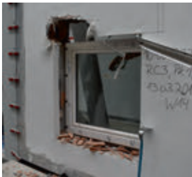
Bild 44. Tastversuch zum Erreichen einer durchgangsfähigen Öffnung bei einem Ziegelrollladenkasten in der Klasse RC 3 (Fotos: Küenzlen)
