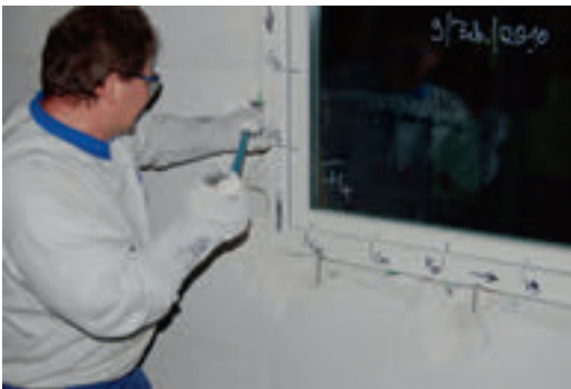
Bild 39. Manueller Einbruchversuch mit dem ca. 700 mm langen Kuhfuß [5]
