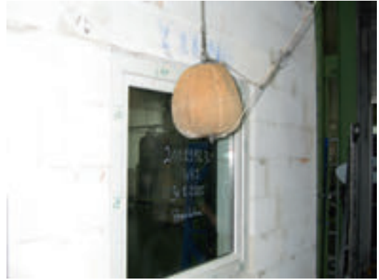
Bild 1. Dynamischer Versuch mit einem Sandsack (30 kg) [2]
