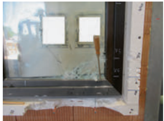
Bild 51. Schadensbild bei einem Randabstand des Befestigers zur Außenkante des System EPS von 95 mm nach rund 6 Minuten bei einer Kombinationsprüfung in der Klasse RC2 (Foto: ift Rosenheim [27])
