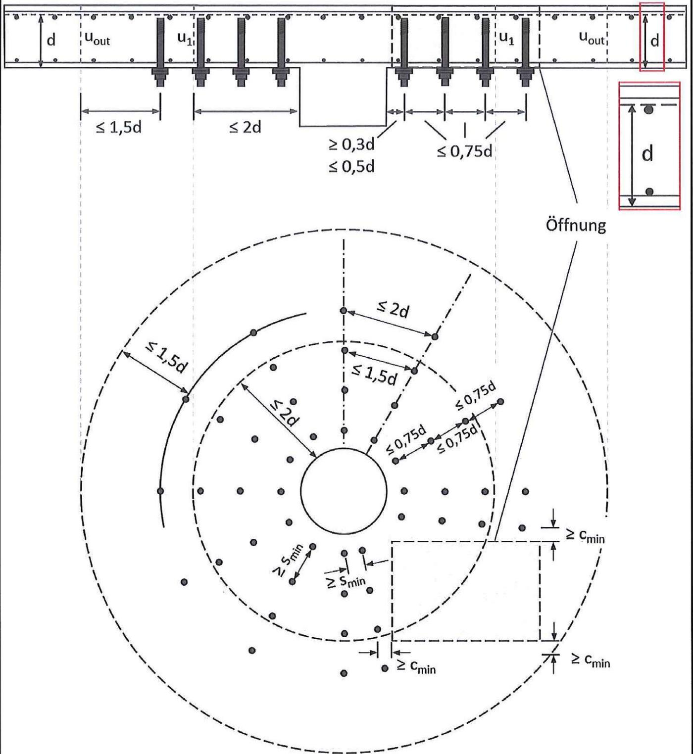
Würth Verbundankerschraube RELAST für die Durchstanzverstärkung
