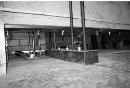
**Bild 14.** Biegeversuch mit externer Bewehrung in Form von Stahllaschen und Verbundankerschrauben als Verbindungselement
