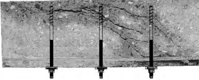
**Bild 18.** Sängschnitt längs durch einen Versuchskörper nach den durchgeführten Querkraftversuchen (aus [18])
