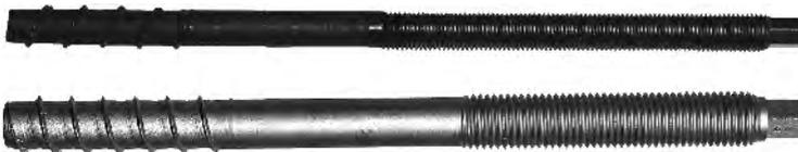
**Bild 7.** Betonschrauben mit Nenndurchmesser  $d_0 = 16$  mm und  $d_0 = 22$  mm und metrischem Anschlussgewinde M16 bzw. M24 sowie Sechskant zum Eindrehen
