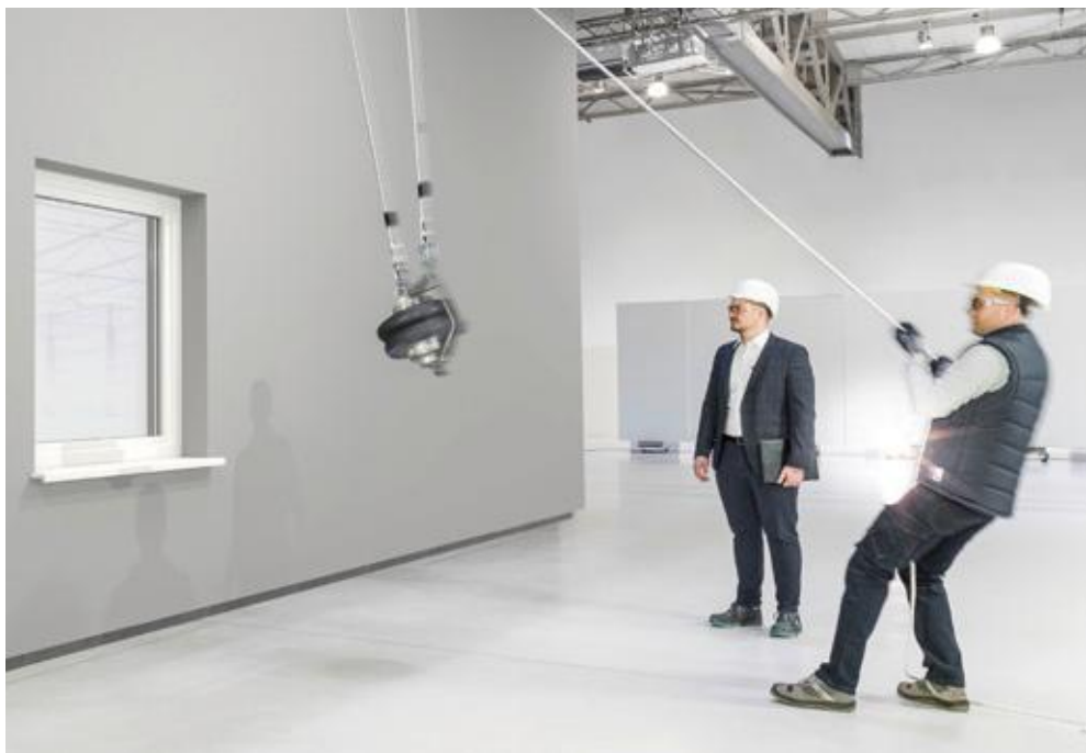
Prüfung der Fensterbefestigung mittels Pendelschlägen gemäß Norm – Test zur Widerstandsfähigkeit gegen dynamische Belastungen
