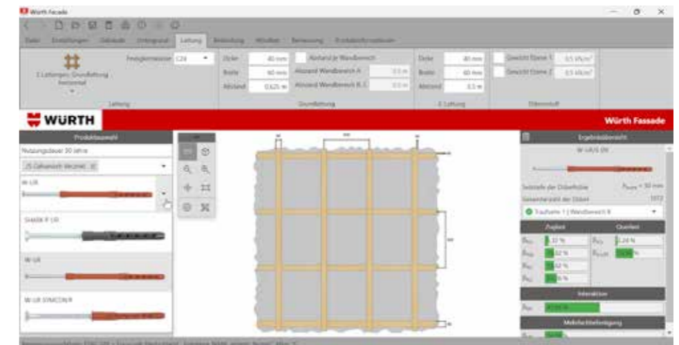
Modul Fassade der Würth Technical Software
