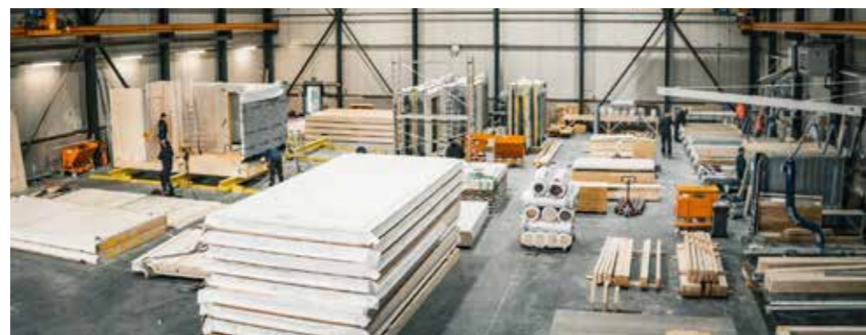
Werkhalle in Bad Bentheim für die Vorfertigung von Wand-, Boden- und Deckenelementen.
