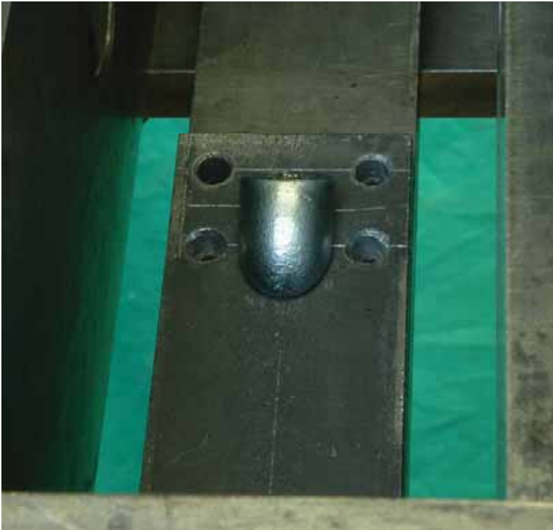
Bild 5: Versuchsaufbau – Montageplatte mit eingesetzter Winkelscheibe
