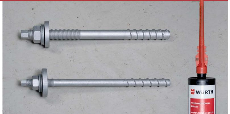
Die Verbundankerschraube RELAST besteht aus einem beton-schneidenden Gewinde auf der einen und einem genormten ISO-Anschlussgewinde auf der anderen Seite. Injektionsmörtel, Druckverteilungsscheibe, Keilversicherungsfederscheibe und Sechskantmutter komplettieren das System. Die Schraube ist je nach Anwendung zwischen 15cm und 2m lang.
