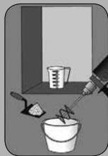
Mörtel trocken vermischen. Erst Wasser, dann Mörtel in den Mischbehälter. 3 Min. mischen bei 300-400 U/min.
