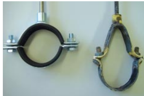
Bild 10: Rohrschellen vor und nach Brandbeanspruchung
