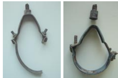
Bild 11: Schellenversagen infolge Brandbeanspruchung Linkes Bild: Gelenkversagen Rechtes Bild: Versagen im Bereich der Gewindemuffe
