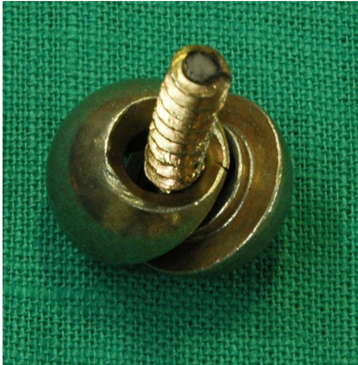
Bild A 4: Prüfkörper Konfiguration 3 – Rissbildung an aufliegender Winkelscheibe
